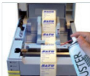
2. Ouvrir le capot de l'imprimante et vérifier qu'il n'y a pas de résidus sur le passage et les guides des étiquettes. Si nécessaire, utiliser le spray dépoissierant pour enlever la poussière à l'intérieur de l'imprimante.
