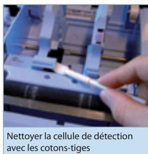
Nettoyer la cellule de détection avec les cotons-tiges
