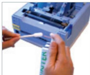
6. Utiliser des cotons-tiges de nettoyage et un pulvérisateur ou bien le papier absorbant avec le pulvérisateur pour imprimante, afin d'enlever les résidus collés sur la tête d'impression. Vérifier que la ligne des points d'impression est parfaitement nettoyée.
